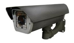
屋外ハウジング、赤外線LED、レンズ、ブラケット付属 2DNR(デジタルノイズリダクション)内蔵 水平解像度700本 レンズ焦点距離 2.8-12mm/5-50mm(注文時指定) 赤外線LED 46個/47個(モデルにより異なる) 赤外線照射距離 40m/80m(モデルにより異なる) スマートIR
