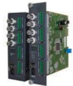
カメラ~閲覧場所まで、光ケーブル1本で伝送。信号減衰の心配なく、工事コスト、作業量の削減に効果
