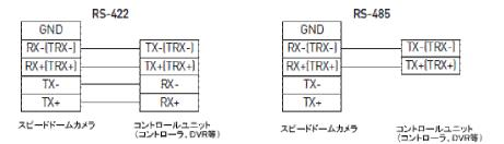
スピードドームカメラとコントロールデバイス(コントローラ TPD-400-SCT や各種デジタルレコーダー)は、RS485で通信制御します。
