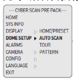
オートスキャンは、8プログラムまで登録できます。次の 手順でプログラムを設定します。「DOME SETUP」 「AUTO SCAN」を選択します。「ENT」を押すか、ジョイ スティックを右に振ります。
