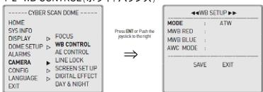
ATW(Auto Trace White Balance): 色温度 2000~10000K の光源変化に応じて、ホワ イトバランスを自動調整します。
