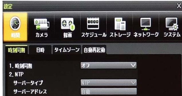
NTP を選択後、NTP サーバータイプとサーバーのアドレスを選択します。
