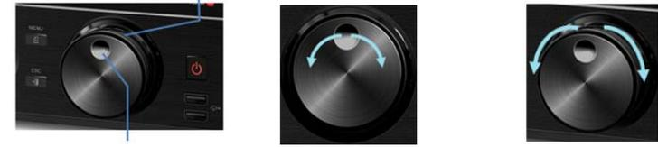
フレーム操作 再生・逆再生に使用 再生スピード操作 1/2/4/30 倍速
