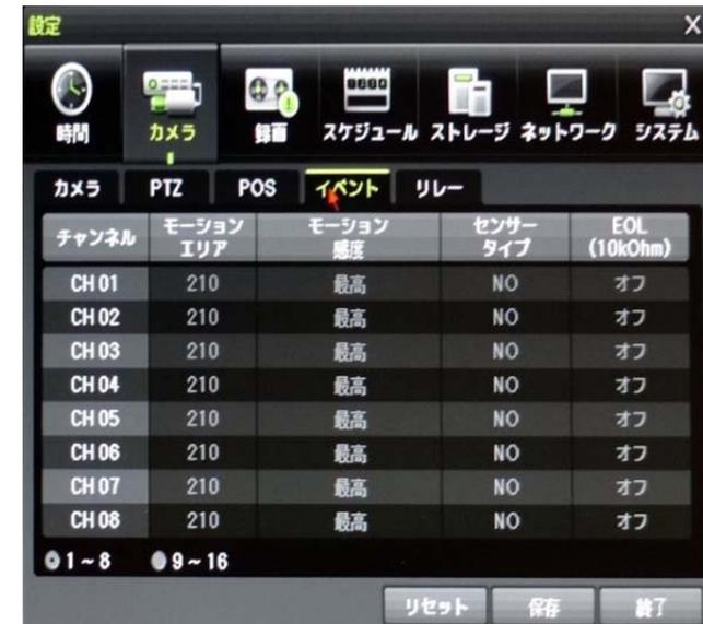
①モーションエリア：画像上の動き検知エリアを設定します。
