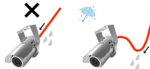
ケーブルをカメラより高い位置に配する場合、一度カメラ位置より下に降ろしてから入線する配置にします。露がケーブルを伝い、カメラへ本体に浸透することで、カメラ内部に浸水する場合があります。
