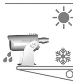
製品仕様の範囲内の環境に設置してください。仕様を超える環境でのご使用の場合、保証の対象外です。屋外に設置する場合は、直射日光を避け、日陰などに設置ください。炎天下で熱が本体に蓄積されると、カメラの稼働に支障を来します。
