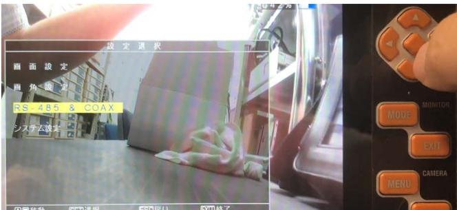
③モード(Coaxial)/プロトコル (A-CP)を選択＞「開始」へ移動＞上下左右の真ん中の◆ボタンを押す
