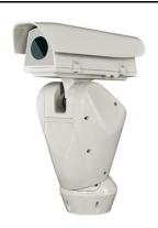
光学3倍電動ズームレンズ(f35-105mm)搭載電子ズーム8倍トータル24倍ズームオートフォーカス機構内蔵ダイナミックコントラスト調整水平回転 360°Cエンドレス 100°/秒垂直回転 -40°~90° 50°/秒プリセット精度 0.02° バックラッシュ ゼロスリップリング、電子リミットスイッチ動作環境温度 -40°C~65°C
